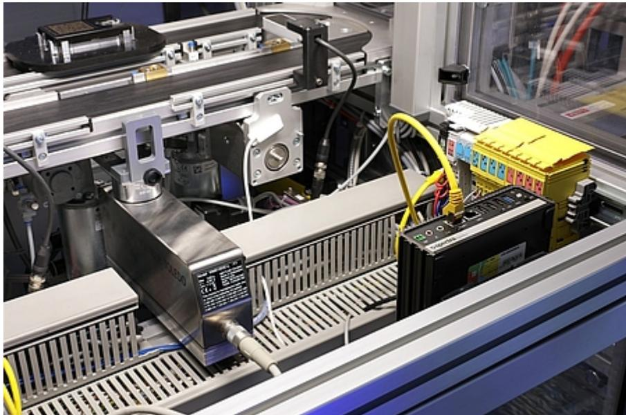
Ein Beispiel für den Einsatz von Edge-Devices an der Industrie-4.0-Anlage in der SmartFactory KL findet sich am Wägemodul zur Qualitätssicherung.
