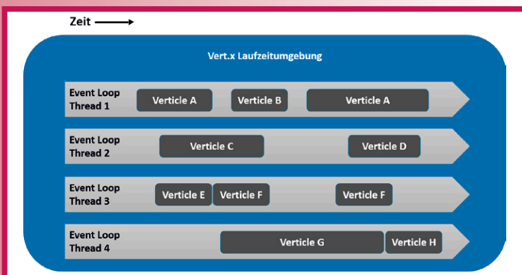
Abb. 2: Dynamische Sicht: Verticles laufen auf Event-Loop-Threads
