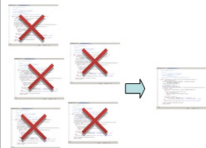
Abb. 5: Problem Server-Fassade: die generierten Klassen lassen sich durch Aufruf einer generischen Klassen ersetzen
